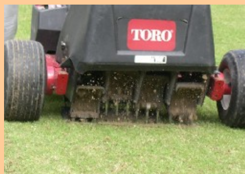
機械についている鉄のつめを土にさして穴をあけていきます。
